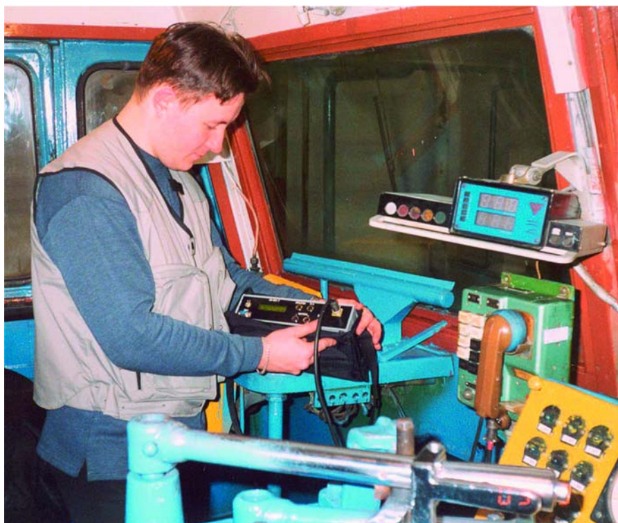
Измерение параметров поездной радиостанции прибором ПИ-ПРС-7 непосредственно на локомотиве
