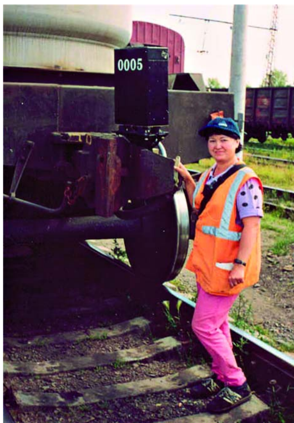
Вагонный полукомплект УКТМ, установлен на хвосте поезда
