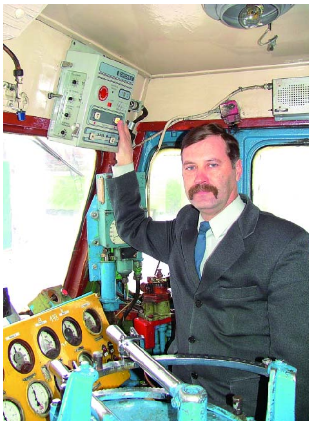
Носимый блок ТУ-ТС системы КОНСУЛ-Т, расположение в кабине локомотива
