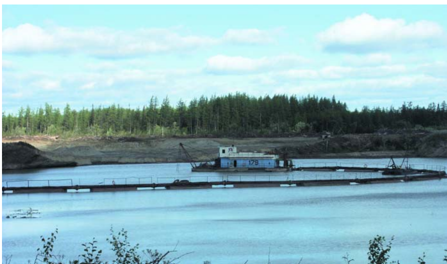
Разработка карьера земснарядом 180-60
