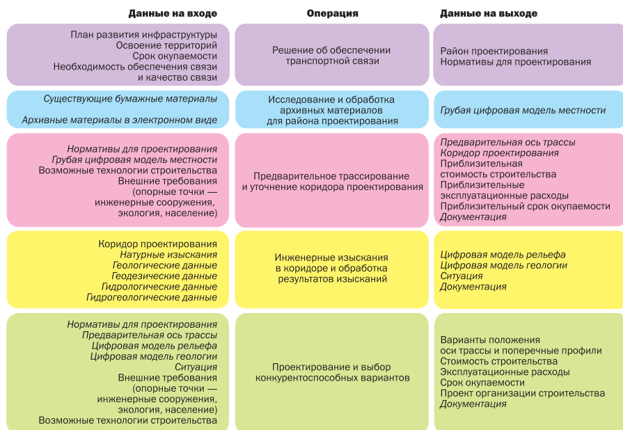
Рис. 1. Технологическая последовательность действий при выполнении проекта новой дороги
