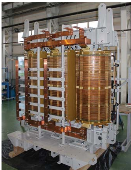
Рис. 3. Сухой трансформатор с твердой изоляцией, мощность до 12,5 МВА, напряжение обмоток до 24 кВ
