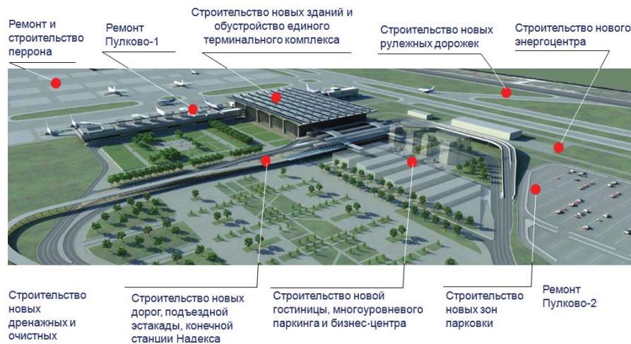
Рис. 1. Работы по модернизации аэропорта Пулково по проекту ГЧП
