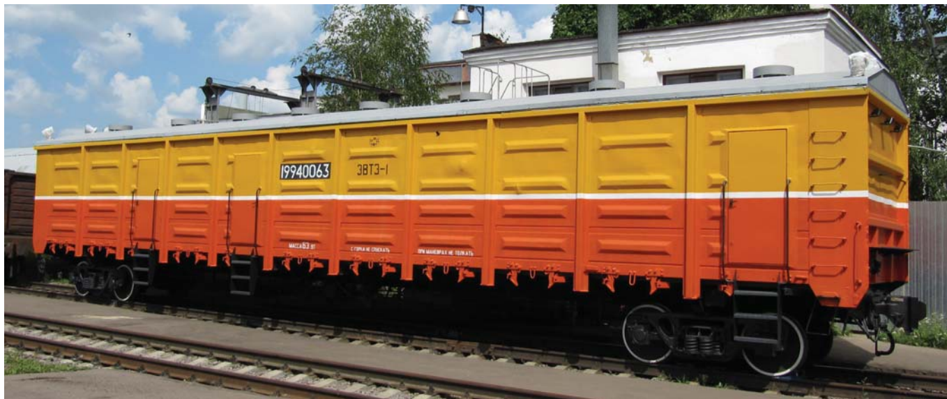
Рис. 2. Энергетический вагон для питания путевой техники
