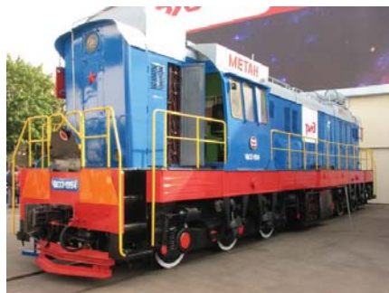
Рис. 1. Тепловоз ЧМЭЗ, переоборудованный для работы на природном газе в газодизельном цикле
