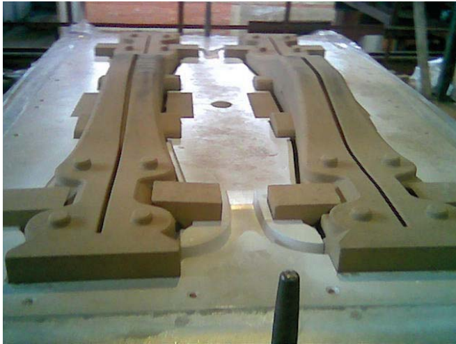
Рис. 6. Нижняя полуформа с предложенной литниково-питающей системой
