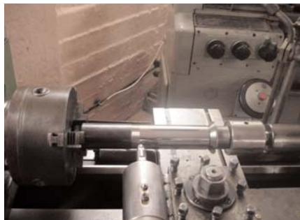
Процесс ультразвуковой финишной обработки детали на токарном станке
