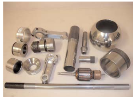
Образцы деталей, обработанные ультразвуком
