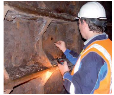
Рис. 8. Оценка степени коррозионного износа чугунной обделки вентиляционной шахты с помощью ультразвукового толщиномера А1208
