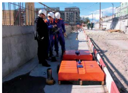
Рис. 5–6. Оценка качества ограждения котлована из грунто-цементных свай и состояния грунтового массива за обделкой тоннеля с помощью георадара
