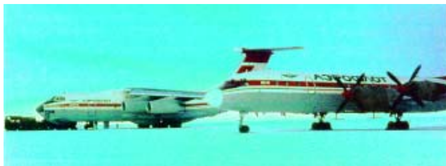
Рис. 4. Самолеты ИЛ-76ТД и ИЛ-18Д на классифицированном высокопрочном снежном аэродроме в Антарктиде.
