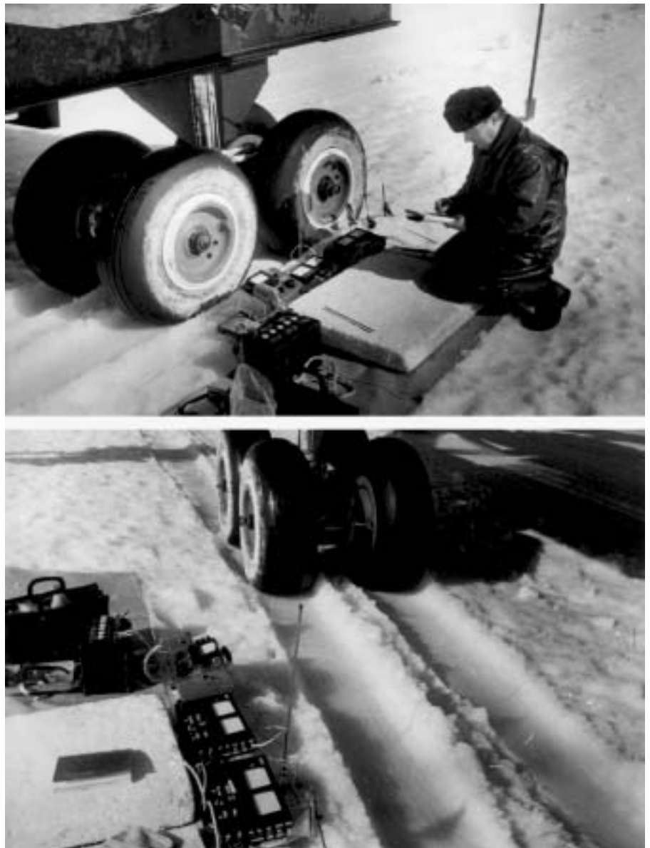
Рис. 2. Натурные испытания распределения напряжений в снежнофирновом покрове Антарктиды под воздействием колесного шасси самолета: а) при расположении шасси над заглубленными месдозами, б) остаточная деформация (колея) в снежном покрытии после съезда шасси с точки измерения напряжений
