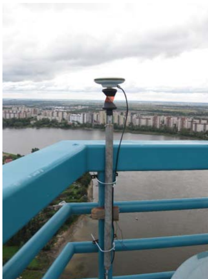
Рис. 2. Спутниковые геодезические приемники, закрепленные на мосту
