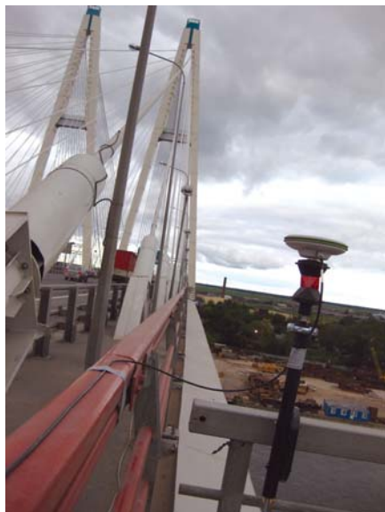
Рис. 2. Спутниковые геодезические приемники, закрепленные на мосту
