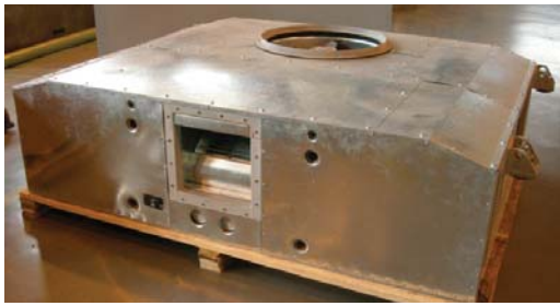
Рис. 2. Общий вид кондиционера УК ПВ
