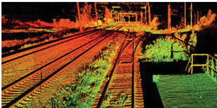
Рис. 1. Изометрический вид объекта съемки, полученный на основе облака точек
