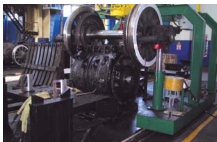
Рис. 10. Технологическая позиция сборки колесно-моторных блоков локомотивов (патент на п. м. 46966)
