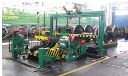
Рис. 9. Технологическая позиция разборки колесно-моторных блоков локомотивов
