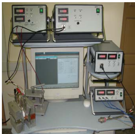
Рис. 5. Автоматизированный комплекс для испытания силовых полупроводниковых приборов
