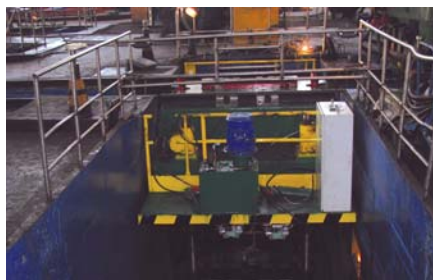
Рис. 7. Технологическая позиция (скатоподъемник) для выкатки и подкатки колесно-моторных блоков
