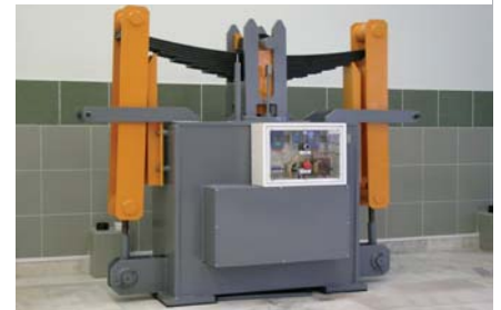
Рис. 3. Автоматизированный стенд для испытания листовых рессор подвижного состава
