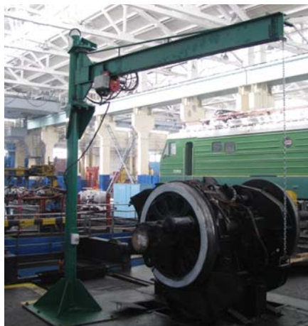
Рис. 8. Технологическая позиция снятия кожухов тяговой зубчатой передачи
