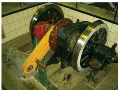
Рис. 12. Стенд динамического контроля колесно-редукторных блоков
