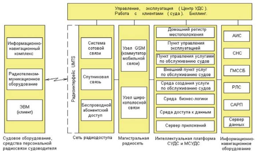
Инфраструктура конвергируемой системы управления движением судов морского порта: АИС — автоматическая информационная (идентификационная) система; СНС — спутниковая навигационная система; ГМССБ — глобальная морская система связи при бедствии, РЛС — радиолокационная станция; САРП — система автоматической радиолокационной прокладки
