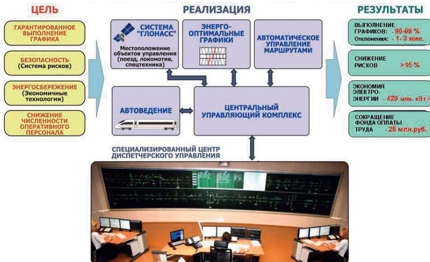
Рис. 8. Автоматизированный программно-технический комплекс управления движением поездов на направлении Санкт-Петербург — Москва
