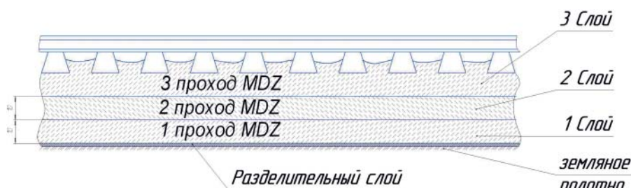
Рис. 1. Технология формирования, уплотнения и стабилизации балластной призмы после глубокой очистки щебня фирмы Plasser & Theurer
