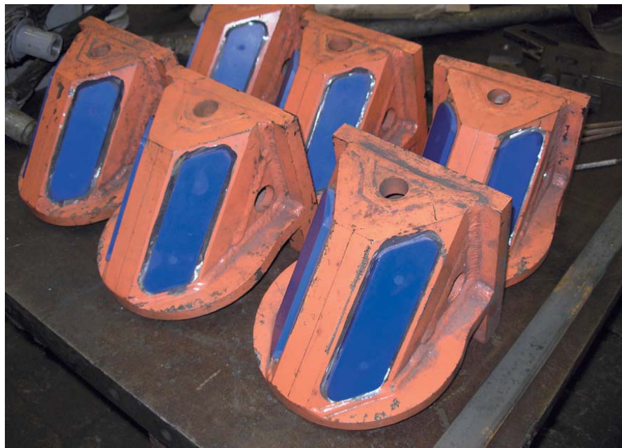
Рис. 3. Пространственная конструкция клина тележки модели 18-9750.
