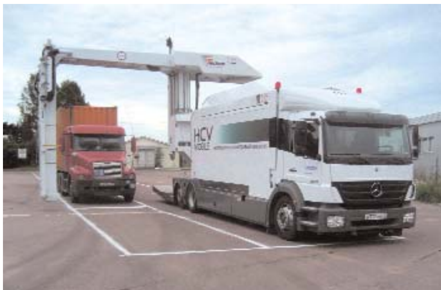
Мобильный инспекционно-досмотровый комплекс.
