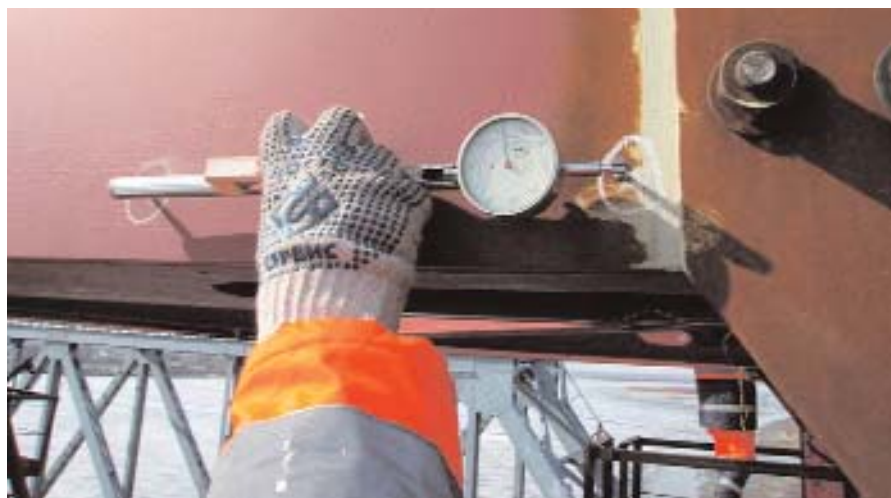
Рис. 3. Механическая система для контроля НДС, установленная на верхнем поясе строящегося моста через р. Обь в г. Камень-на-Оби.
