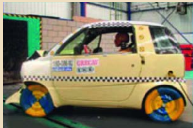
Рис. 4. Тесты пассивной безопасности модели квадрицикла фирмы Gresav S.p.A. (Gonzaga). Иллюстрации фирмы-производителя
