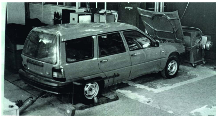
Рис. 6. Вид гибридного электромобиля на стенде с беговыми барабанами
