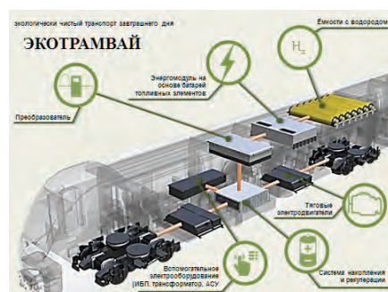
Рис. 5. Схема размещения оборудования в городском водородном трамвае
