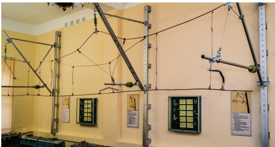
Стенд современной контактной подвески КС-160 в Центральном музее железнодорожного транспорта РФ (внизу); старая экспозиция (вверху слева); монтаж элементов КС-160 (вверху справа).
