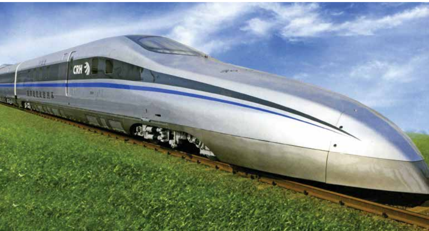
Рис. 6. Опытный высокоскоростной поезд с конструкционной скоростью 380 км/ч. КНР
