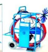
Установка Reel Master была специально разработана для очистки воздуховодов систем вентиляции. При
