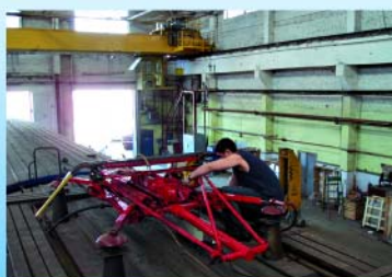
Система КОМПАКС-ЭКСПРЕСС-2. Комплексная диагностика электросекций — цех ТР-3
