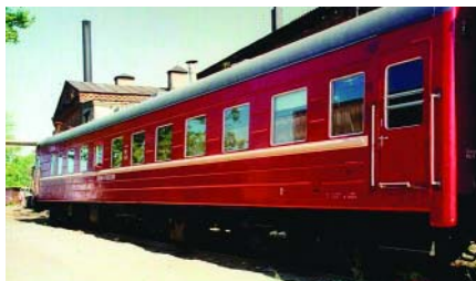
Рис. 3. Совмещенный вагон-дефектоскоп с аппаратурой АВИКОН-03М
