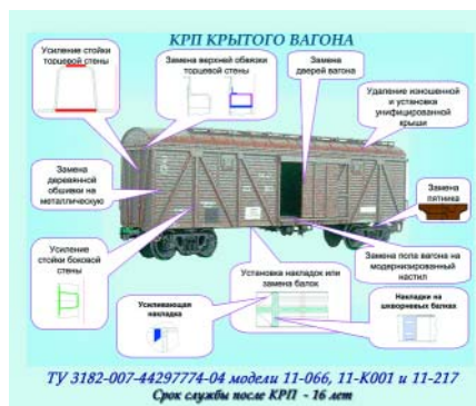
Основные работы, выполняемые при КРП крытого вагона
