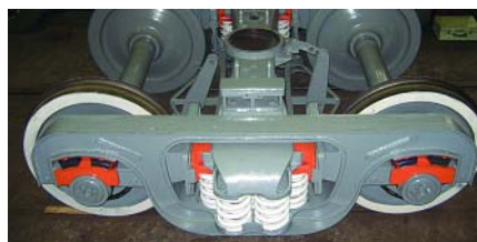
Тележка модели 18-9750 для грузовых вагонов с осевой нагрузкой 25 т (совместная разработка НВЦ «Вагоны» и ПГУПС, изготовитель ЗАО «НО ТИВ»)
