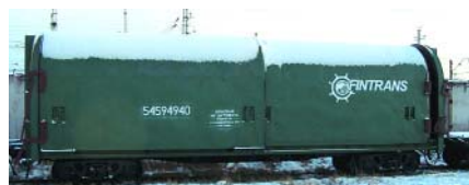
Крытый вагон с защитными сдвижными кожухами
