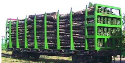
Платформа модели 13-4012-24 при перевозке лесоматериалов в зональном габарите погрузки
