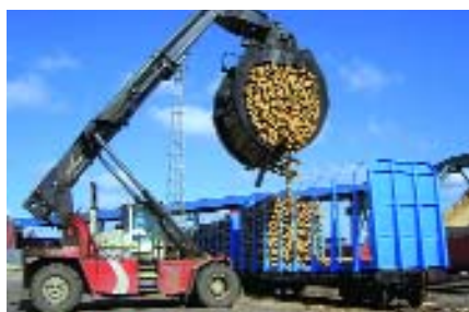
Съемное оборудование из высокопрочной стали для перевозки леса (совместная разработка НВЦ «Вагоны» и АО «РП-Хитсаус», Финляндия, модель 13-4012-20)
