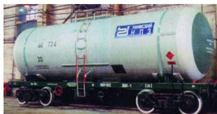
Вагон-цистерна для перевозки нефтепродуктов (модель 15-9735)
