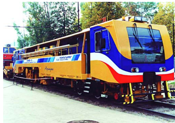
Выправочно-подбивочная машина непрерывного действия ПМА-1 «Ариадна»
