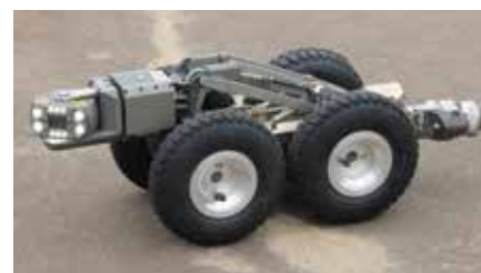
Телеметрический робот для обследования ВДС
