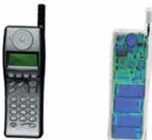
Рис. 5. Модель сотового телефона. Видны аккумуляторы, динамики и антенна
