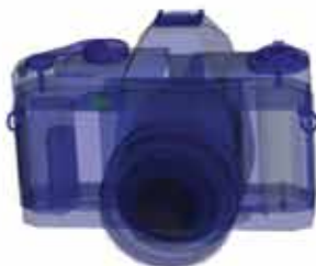
Рис. 3. Фотоаппарат. По теневому изображению видно, что линзы содержат ионы тяжелых металлов, в результате получается экранирующий эффект
