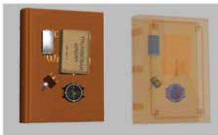
Рис. 7. Самодельное взрывное устройство (СВУ) в книге. На теневом эквиваленте виден источник питания, заряд ВВ с детонатором, замедлитель (часы наручные), тумблер, медные провода
