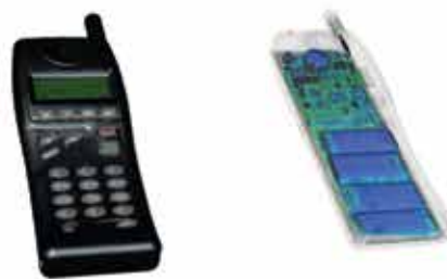
Рис. 6. Та же модель сотового телефона, повернутая под углом. На теневом изображении выделяются элементы на плате и антенна
