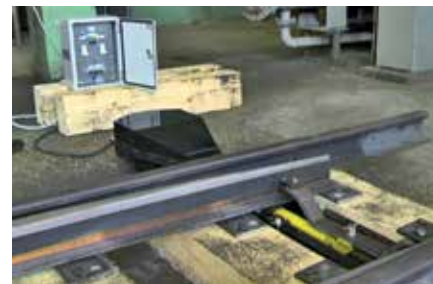
Рис. 2. Испытания рудничного стрелочного привода УК-Р33-750
