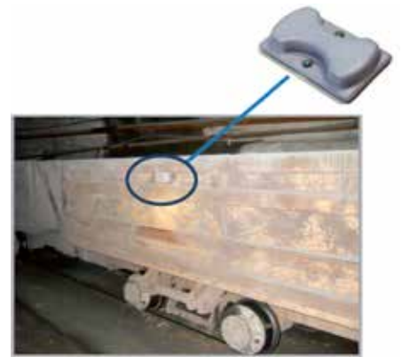
Рис. 2. Размещение SAW RFID-метки на вагонетке
