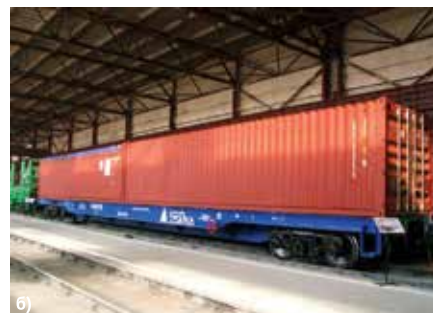
Рис. 2. Общий вид контейнерной платформы погрузочной длиной 80 футов:
