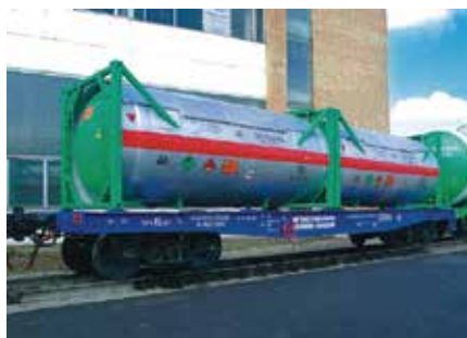
Рис. 1. Общий вид контейнерной платформы погрузочной длиной 40 футов производства ОАО «Рузхиммаш», модель 13-5001
