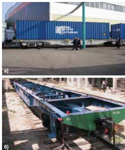
Рис. 3. Общий вид сочлененной контейнерной платформы: а – производства АО «Tatravagonka a.s.», модель 13-9851; б – производства ОАО «Азовмаш», модель 13-1839
