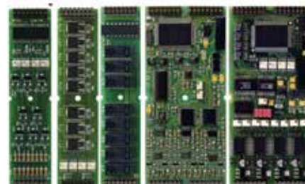
Рис. 5. Типовые мезонины ввода-вывода сигналов
