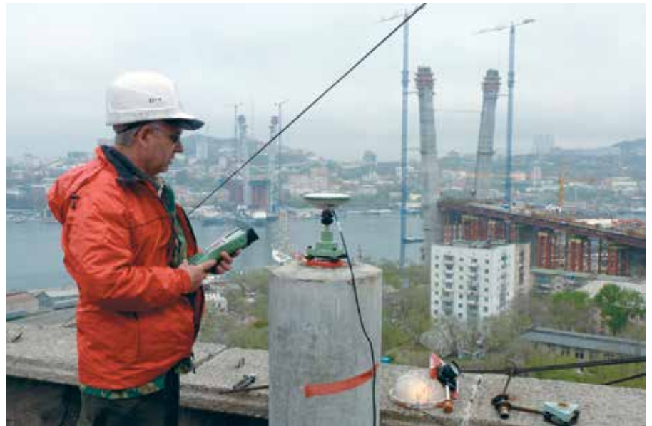
Рис. 4. Измерения GPS-приемником на пункте геодезической разбивочной сети
