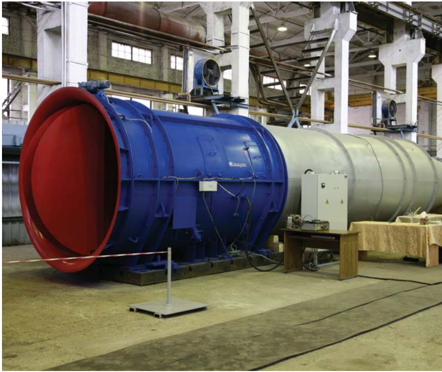
Рис. 5. Вентилятор ВОМД 24 модернизированный на стенде
