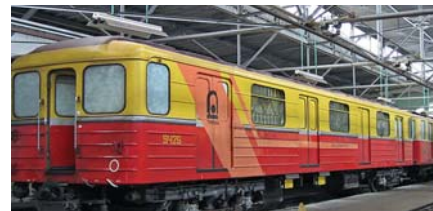
Рис. 2. Вагон-дефектоскоп № 9425, электродепо «Красная Пресня»
