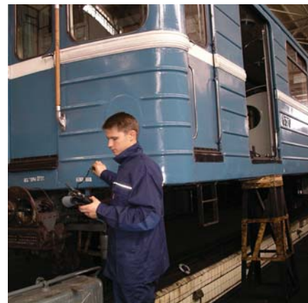
Рис. 3. Эксперт Лаборатории НК и ТД ОАО «НВЦ «Вагоны» С. В. Борисов проводит толщинометрию кузова вагона метрополитена.
