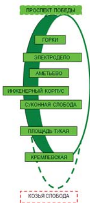
Система «ВОЛС». Отказоустойчивая структура «Кольцо»
