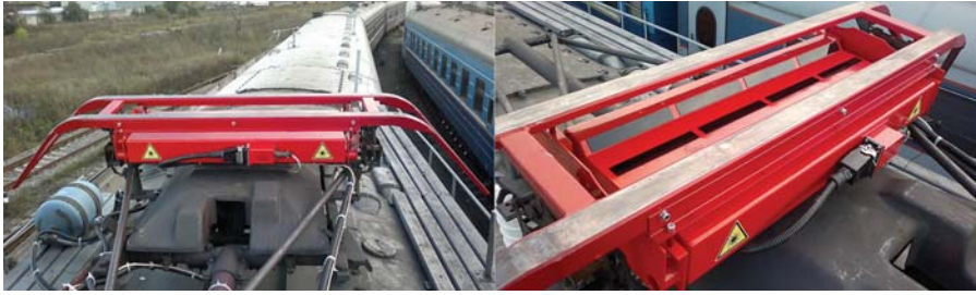
Рис. 2. Измерительный токоприемник вагона-лаборатории ВИКС ЦЭ с блоком «Износ»
