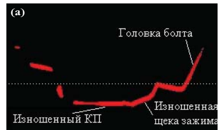
Рис. 3. Серия кадров, фиксирующих КП при движении вагона в солнечный день
