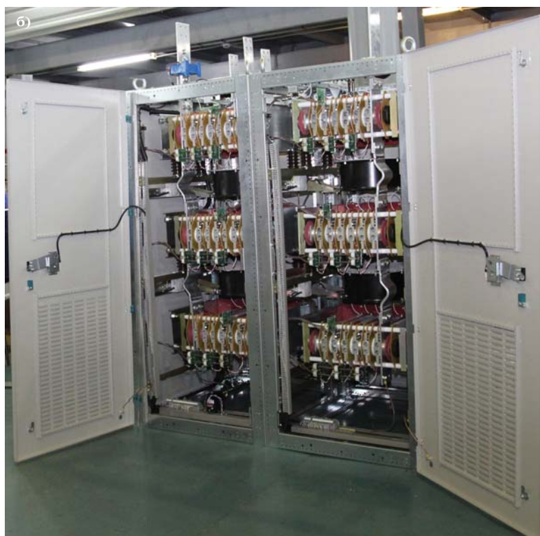
Рис. 1. Двенадцатипульсовый инвертор, разработанный для использования при строительстве новых тяговых подстанций: панель управления (а), преобразователь (б).
