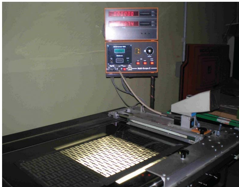
Рис. 3. Шаблон травления дорожек нагревательных элементов на фольгированном стеклотекстолите
