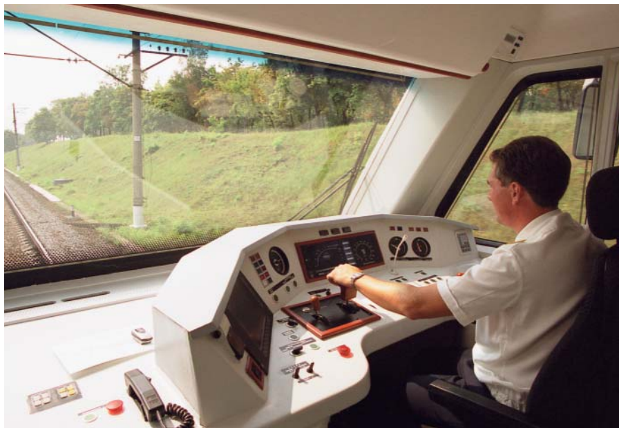
Кабина машиниста с устройством безопасности «КЛУБ-У»
