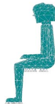
Рис. 4. Форма колебания модели оператора на частоте 7,93 Гц
