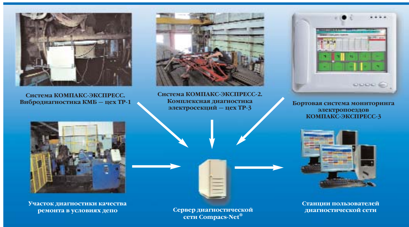
Рис. 6. Структура мониторинга безопасной эксплуатации электропоездов на всех стадиях «жизненного цикла».
