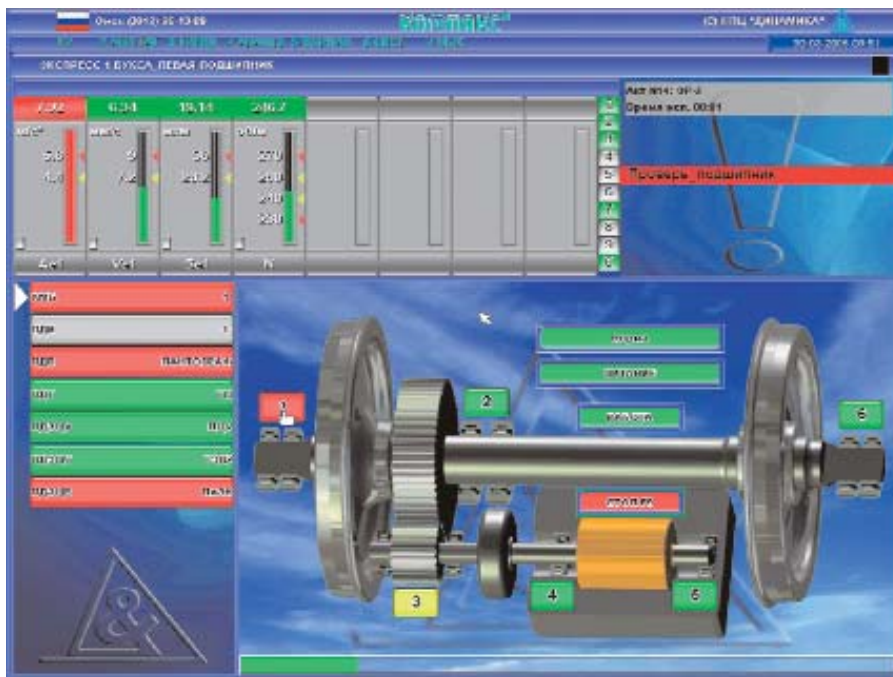
Рис. 3. Экран монитора КСД КОМПАКС-Экспресс-ТР3 подсистемы диагностики колесо-моторных блоков с автоматическим указанием места и вида неисправности.
