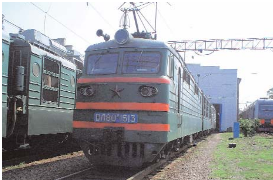
Рис. 4. Опытный электровоз ВЛ80Р №1513 с новым алгоритмом управления выпрямителями и диодными плечами.
