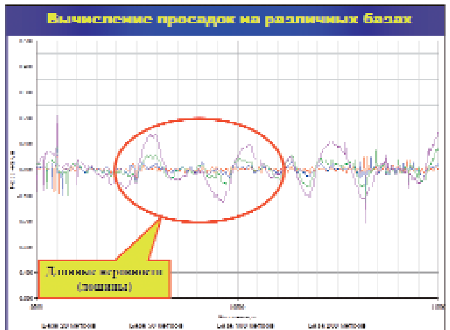
Рис. 4. Определение неровности в вертикальной плоскости в диапазоне хорд от 20 до 200 м.
